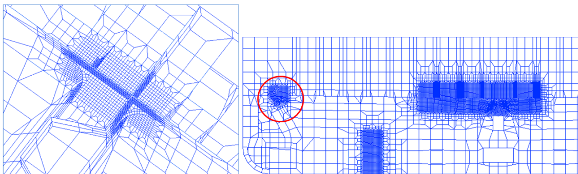
图 3.5.3 槽形横舱壁底凳与底边舱上折角连接处
